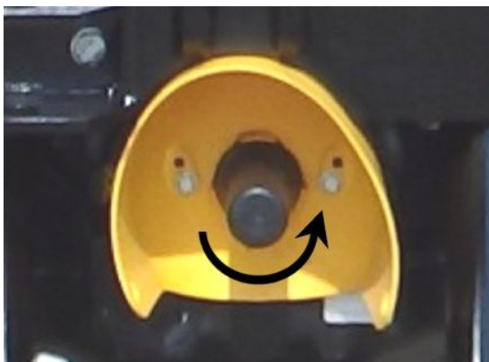
Rys. 4.4. Przedni wałek odbioru mocy (WOM), kierunek obrotów, przeciwnie do ruchu wskazówek zegara.
