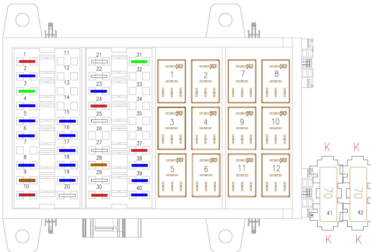
Rys. 5.4.3 Rozmieszczenie bezpieczników i przekaźników w skrzynce bezpieczników.
