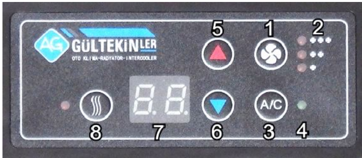
Rys. 3.6. Panel kontrolny automatycznego sterowania klimatyzacją.
