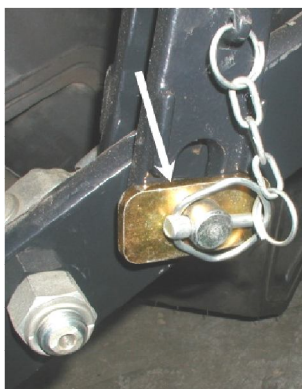
Rys. 4.6.3. Mocowanie wieszaków do cięgł dolnych nieprzesuwnie - łeb i podkładka sworznia ustawione poziomo
