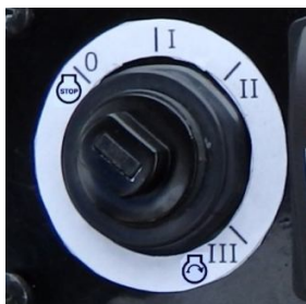
Rys. 4.2. Włącznik zapłonu - z czterema położeniami kluczyka:
