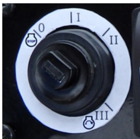
Rys. 4.2. Włącznik zapłonu - z czterema położeniami kluczyka:
