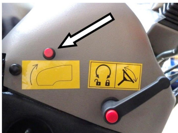
Rys. 4.10. Przycisk otwierania elektromagnetycznego zamka maski silnika.
