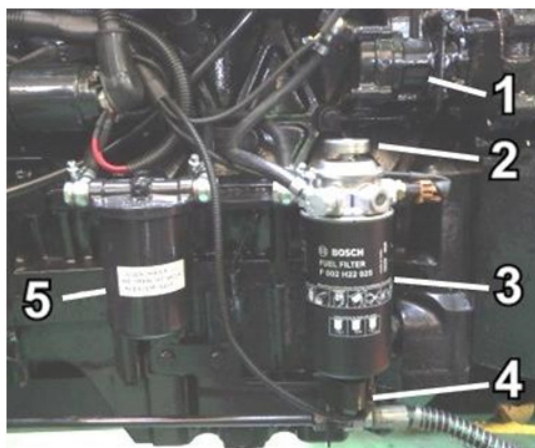
Rys. 5.3.4. Układ zasilania paliwem
