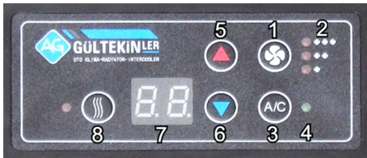
Rys. 3.6. Panel kontrolny automatycznego sterowania klimatyzacją.
