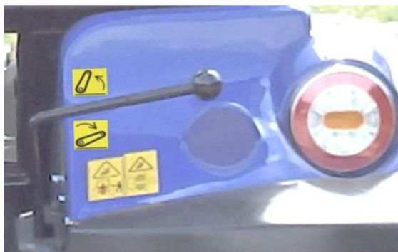
Rys. 4.5.1 Dźwignia sterowania skokowym podnoszeniem TUZ
