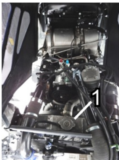
Rys. 5.4.2 Korek wlewu płynu chłodzącego do chłodnicy.
