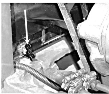
Rys. 5.3.7. Korek spustowy płynu chłodzącego z chłodnicy
