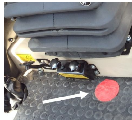
Rys. 5.9.3. Korek wlewu oleju do tylnego mostu i skrzyni przekładniowej (dostęp w podłodze kabiny).
