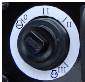
Rys. 4.2. Włącznik zapłonu - z czterema położeniami kluczyka:
