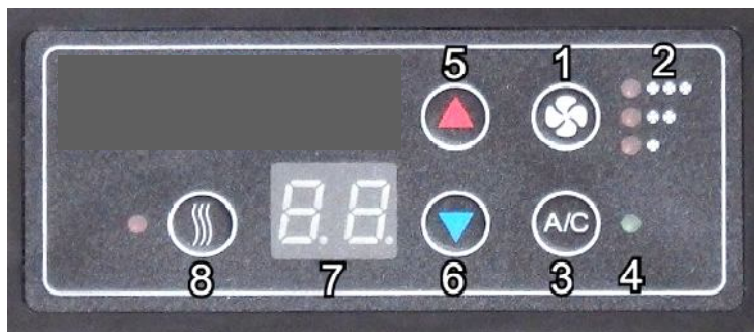
Rys. 3.6. Panel kontrolny automatycznego sterowania klimatyzacją.
