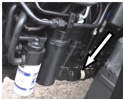
Rys. 5.9.2. filtr oleju hydraulicznego wstępnego oczyszczania
