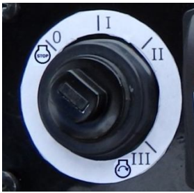
Rys. 4.2.2. Włącznik zapłonu - z trzema położeniami kluczyka: położenie 1 - wyłączzone; położenie 2 - włączone elektryczne urządzenia pomocnicze bez włączania rozrusznika; położenie 3 - włączony rozrusznik (sprężyna powoduje, po zwolnieniu kluczyka, samoczynny powrót do położenia 2).
