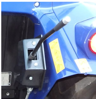
Rys. 4.5.1 Dźwignia sterowania skokowym podnoszeniem TUZ
