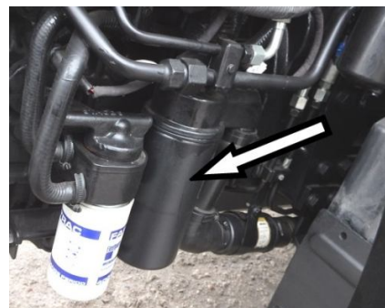
Rys. 5.9.3. filtr oleju hydraulicznego dokładnego oczyszczania
