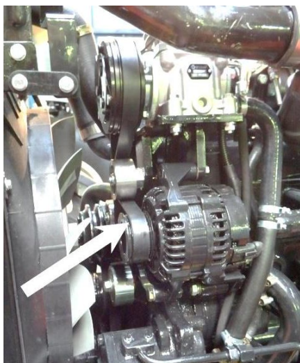
Rys. 5.4.1 Pasek wieloklinowy napędu alternatora, sprężarki powietrza, pompy wody, wentylatora, sprężarki klimatyzacji.
