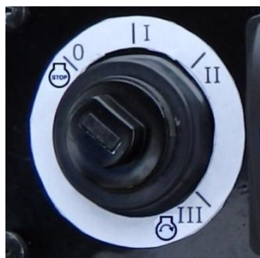
Rys. 4.2. Włącznik zapłonu - z czterema położeniami kluczyka:
