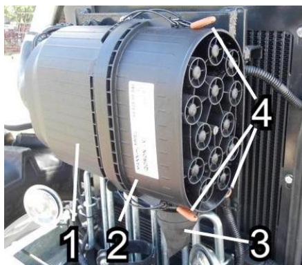
Rys. 5.3.6. Filtr powietrza 1-obudowa, 2- pokrywa, 3- zbiornik pyłu, 4 - zamki mocowania pokrywy, 5- wkład wstępny, 6- wkład dokładnego oczyszczania.
