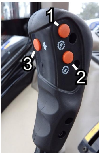
Rys. 3.5. Dźwignia zmiany biegów z przyciskami wzmacniacza momentu.
