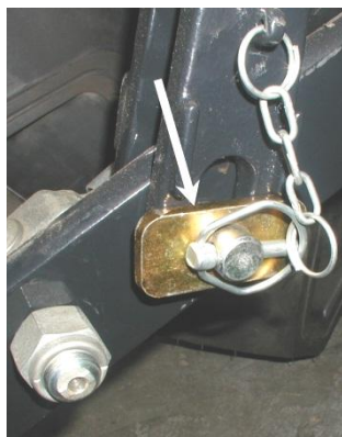
Rys. 4.6.3. Mocowanie wieszaków do cięgła dolnych nieprzesuwnie - łeb i podkładka sworznia ustawione poziomo
