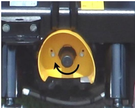
Rys. 4.4. Przedni wałek odbioru mocy (WOM), kierunek obrotów, zgodnie z ruchem wskazówek zegara.
