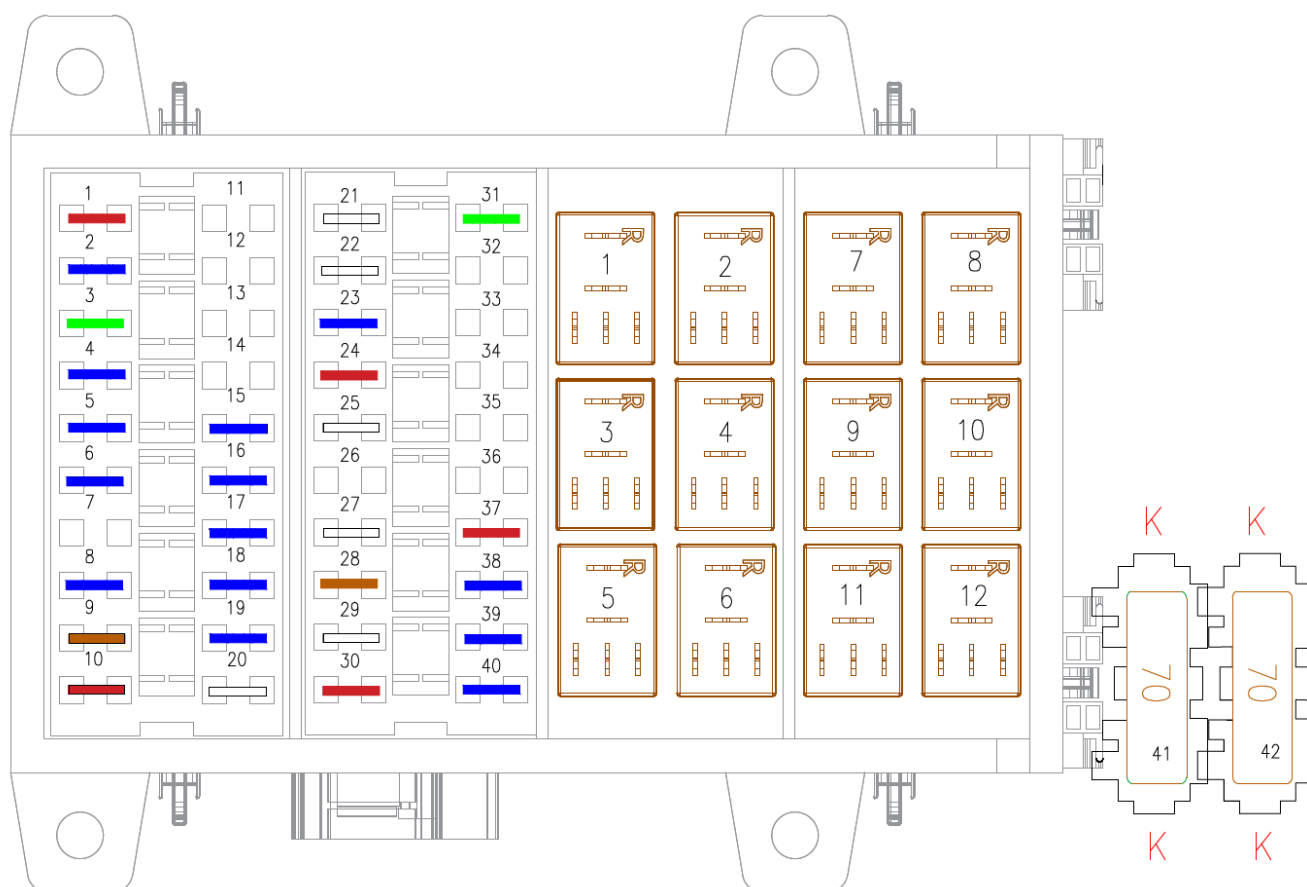
Rys. 5.4.3 Rozmieszczenie bezpieczników i przekaźników w skrzynce bezpieczników.
