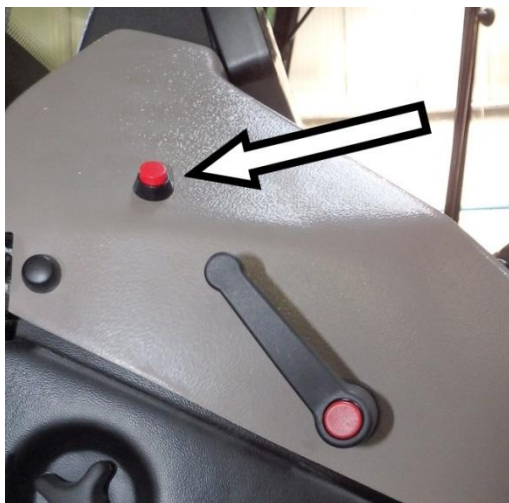
Rys. 4.11. Przycisk otwierania elektromagnetycznego zamka maski silnika.
