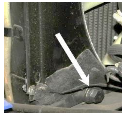
Rys. 5.3.7. Korek spustowy płynu chłodzącego z chłodnicy
