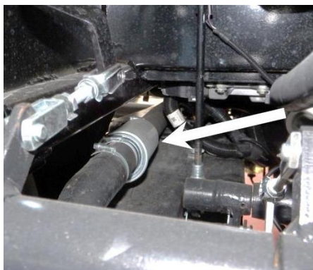
Rys. 5.9.2. filtr oleju hydraulicznego wstępnego oczyszczania
