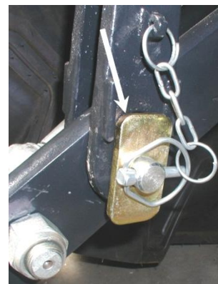
Rys. 4.6.4. Mocowanie wieszaków do cięgła dolnych przesuwnie - łeb i podkładka sworznia ustawione pionowo
