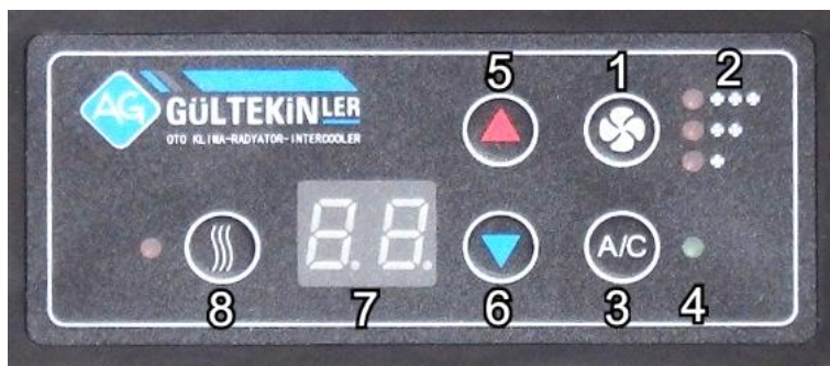
Rys. 3.7. Panel kontrolny automatycznego sterowania klimatyzacją.
