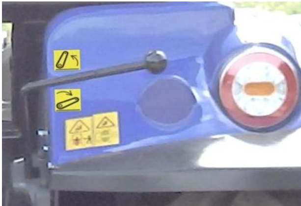
Rys. 4.5.1 Dźwignia sterowania skokowym podnoszeniem TUZ
