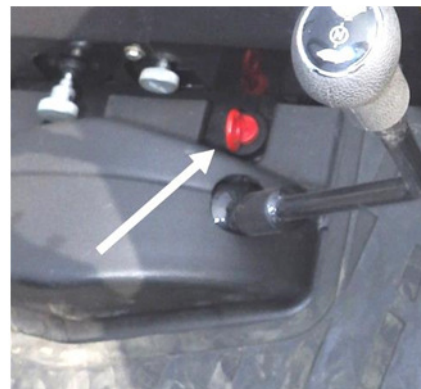
Rys. 5.9.3. Korek wlewu oleju do tylnego mostu i skrzyni przekładniowej (w podłodze kabiny).
