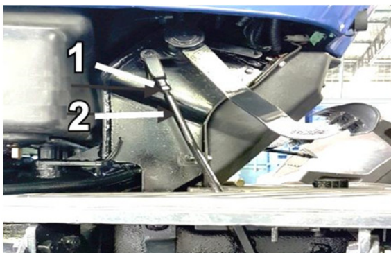
Rys. 5.8. Regulacja skoku pedału sprzęgła
