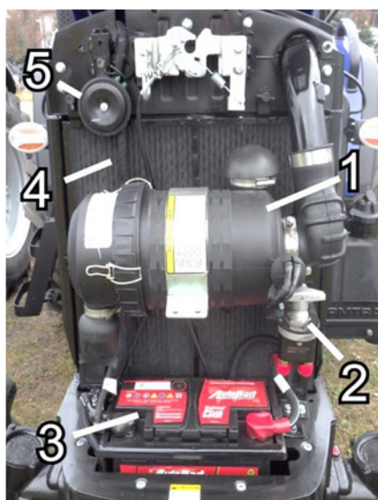
Rys. 5.3.1 Widok przedniej części komory silnika.
