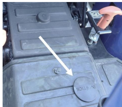
Rys. 5.9.3. Korek wlewu oleju do tylnego mostu i skrzyni przekładniowej
