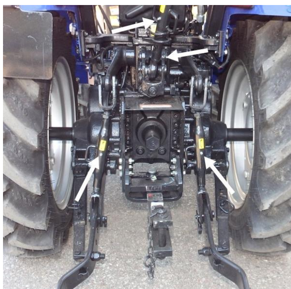
Rys. 5.10 Punkty smarowania TUZ.
