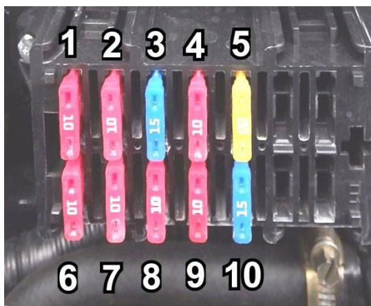
Rys. 5.4.2. Rozmieszczenia bezpieczników w skrzynce
