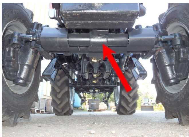
Rys. 4.9. Punkty podparcia podnośnika.
