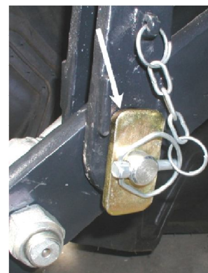
Rys. 4.6.4. Mocowanie wieszaków do cięgł dolnych przesuwnie - łeb i podkładka sworznia ustawione pionowo
