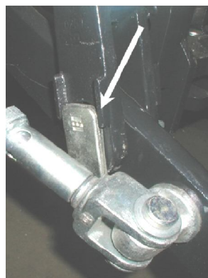
Rys. 4.6.4. Mocowanie wieszaków do cięgł dolnych przesuwnie - łeb i podkładka sworznia ustawione pionowo
