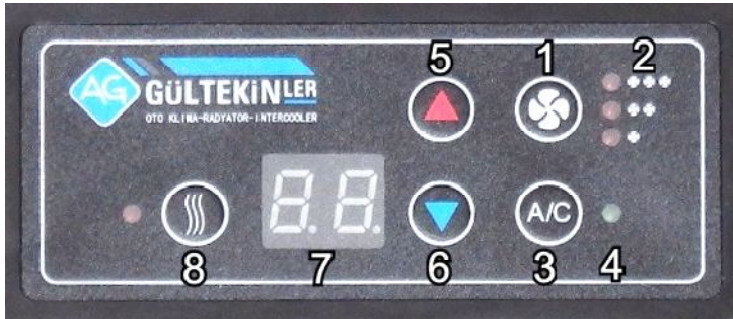
Rys. 3.6. Panel kontrolny automatycznego sterowania klimatyzacją.
