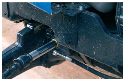
Przewody zasilające siłownik wspomagania są elastyczne.
